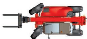
2 ruedas delanteras motrices para garantizar la seguridad en carretera
